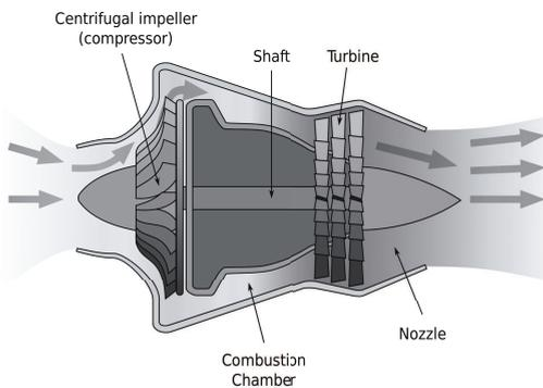
(a) Schematic centrifugal turbojet. [Wikimedia Commons / CC-BY-SA-3.0](#).
